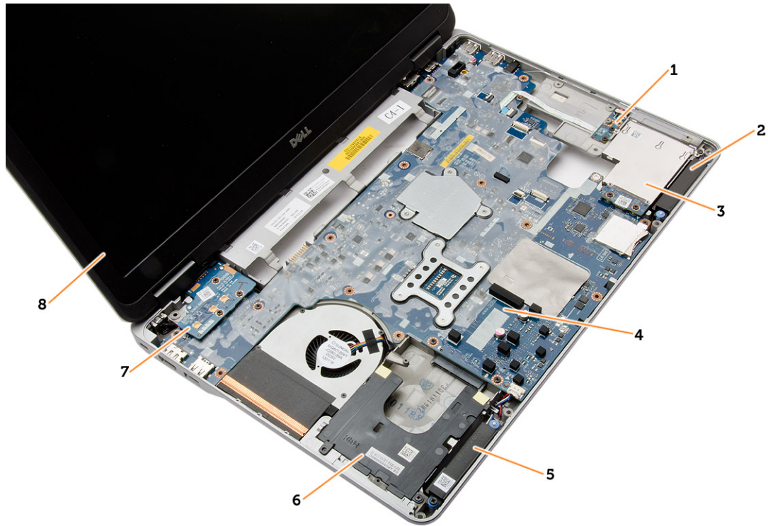
図 2. 上面図 - キーボードとパームレストアセンブリを取り外した状態
